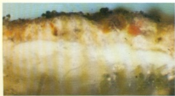
52 - Analisi chimico-fisiche. Osservazione al microscopio ottico di una sezione stratigrafica opaca. Campione 12: dal basso verso l'alto: marmo originale; uno strato compatto di colore bianco (forse una alterazione del marmo); uno strato con particelle giallo-arancio (forse ossidi di ferro); uno strato nerastro di polvere superficiale (prelievo effettuato sul ventre del cigno nel riquadro con la Tellus; fotografia 275x).
