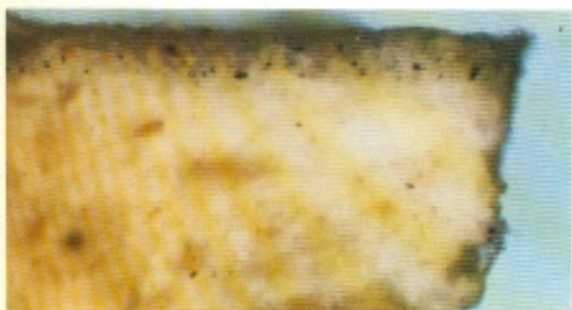
51 - Analisi chimico-fisiche. Osservazione al microscopio ottico di una sezione stratigrafica opaca. Campione 11: dal basso verso l'alto: uno spesso strato di stucco; uno strato continuo con pigmenti nero (nero fumo) e giallo (ossidi di ferro); uno strato di polvere superficiale (prelievo effettuato da una stuccatura del Carradori sul viso del karpos a destra della Tellus; fotografia a 275x).
