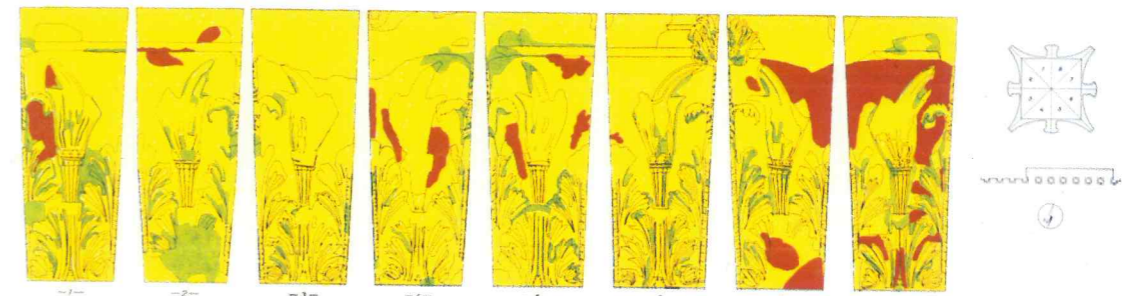
b) TAVOLA A3, SULLA DESCRIZIONE DELLE FORME DI ALTERAZIONE DEL MATERIALE LAPIDEO Legenda: depositi incoerenti o debolmente coerenti (rosso); incrostazioni (giallo); croste nere di tipo dendritico (verde).
