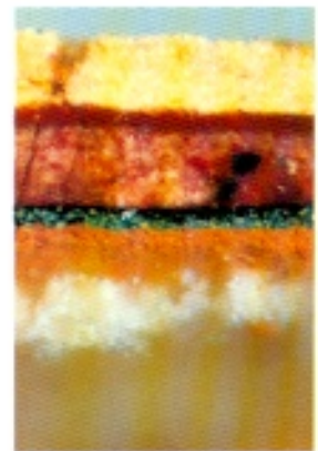
Drappo del trono, sezione stratigrafica. Si individuano a partire dal basso: preparazione a gesso e colla priming; colore bruno del fondo ottenuto con due campiture sovrapposte, la prima aranciata la seconda verde; campitura rosa eseguita in due livelli, con velatura in lacca; spesso strato giallo della decorazione
