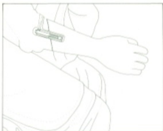
Fig. 2 Particolare del braccio destro, sezione in corrispondenza del perno. Visibile la sede assiale, il canaletto per il piombo, il perno montato.
